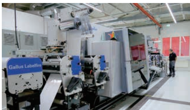
▲ 圖5 - Gallus Labelfire 340印刷設備
