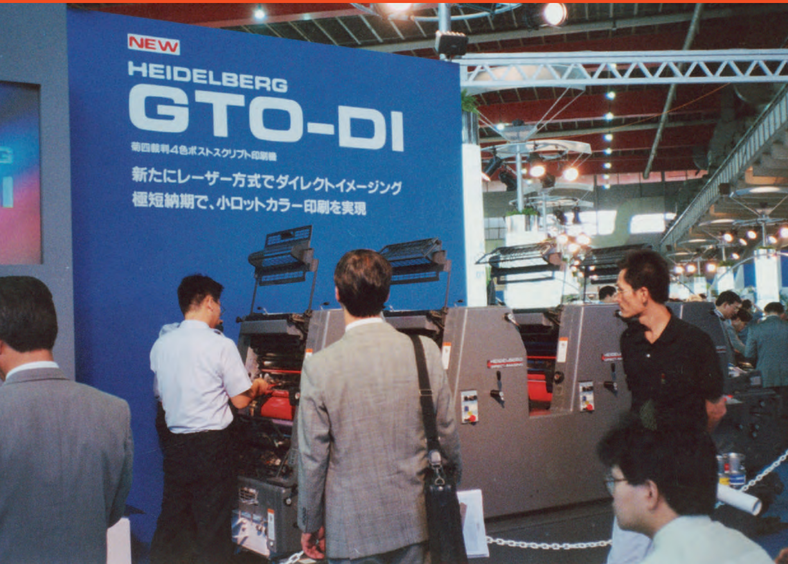
▲圖1 世界第一部機上製版印刷機，海德堡GTO-DI採用鐳針電弧成像，無水平版直接製版印刷機。
